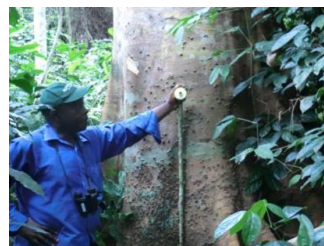
Mesure de hauteur d'arbre avec Vertex
